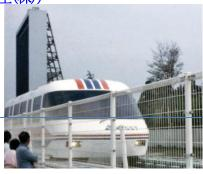
つくば博会場に設置する実験用のリニアモーターカーのレール(全長368m)を製作しました。時速30kmの低速走行ながら、世界で2番目の実用デモ走行に成功しました。
