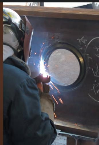
溶接材料は工場施工同様に JIS Z 3312 および JIS Z 3313 に定める 490N/mm<sup>2</sup>級～ 550N/mm<sup>2</sup>級のものを使用下さい。補修溶接に限り JIS Z 3211 (被覆アーク溶接棒) の使用が可能です。
