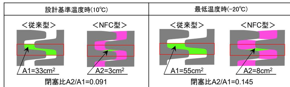
図-3 N-FCフィンガージョイント(S-type)の効果
