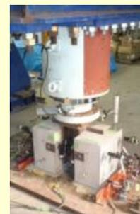
静的押しぬき試験状況および試験結果
